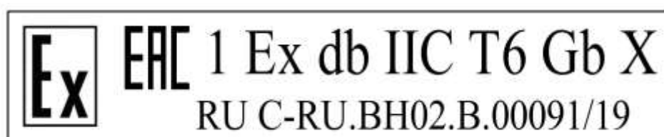
Рисунок А.7 – Табличка маркировки по взрывозащите
