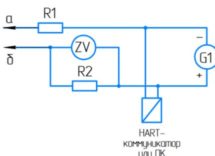
Рисунок Ж.2 – Схема подключения HART-модема к преобразователям
